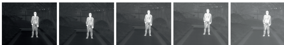
Рис. 3-3. Настройка яркости в режиме «Горячее – белое»
