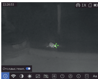
Рис. 4-1. Эффект отслеживания максимальной температуры
